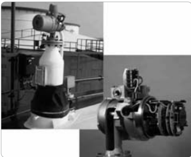
Obr. 24 Meranie výšky hladiny s pokročilými technológiami servomechanizmov
