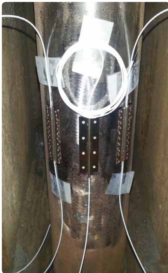
Obr. 1 Inštalácia FBG snímačov pred aplikáciu viacvrstvého krytia
