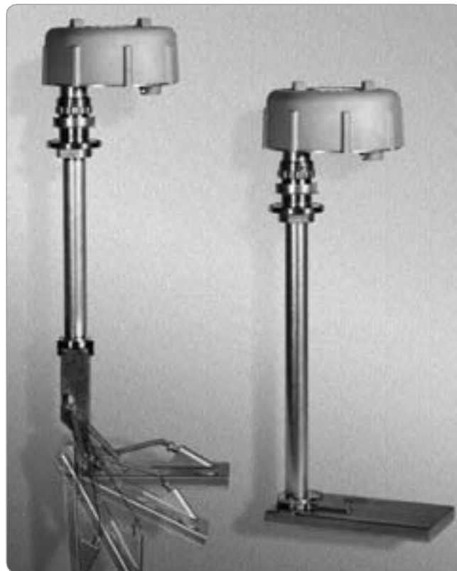
Obr. 25 Radarový systém na meranie výšky hladiny vo veľkoobjemových zásobníkoch s planárnou anténou
