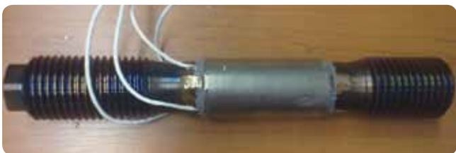
Obr. 3 Inštalácia tenzometrických snímačov na povrchu svorníkov prírubového spoja s viacvrstvom krytím, odolná voči okolitému prostrediu do teploty 250 °C a tiež voči mechanickému poškodeniu počas montáže svorníkov. Vrchná vrstva krytia je vyhotovená z nehrdzavejúceho plechu.
